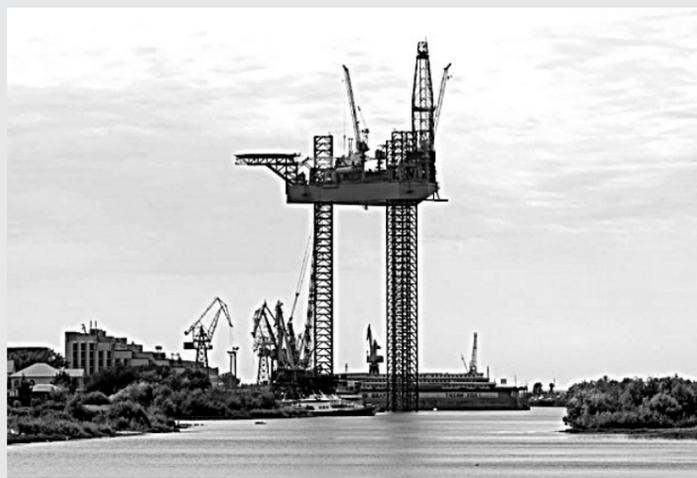
АСПО: самоподъемная плавучая буровая установка «Нептун»
