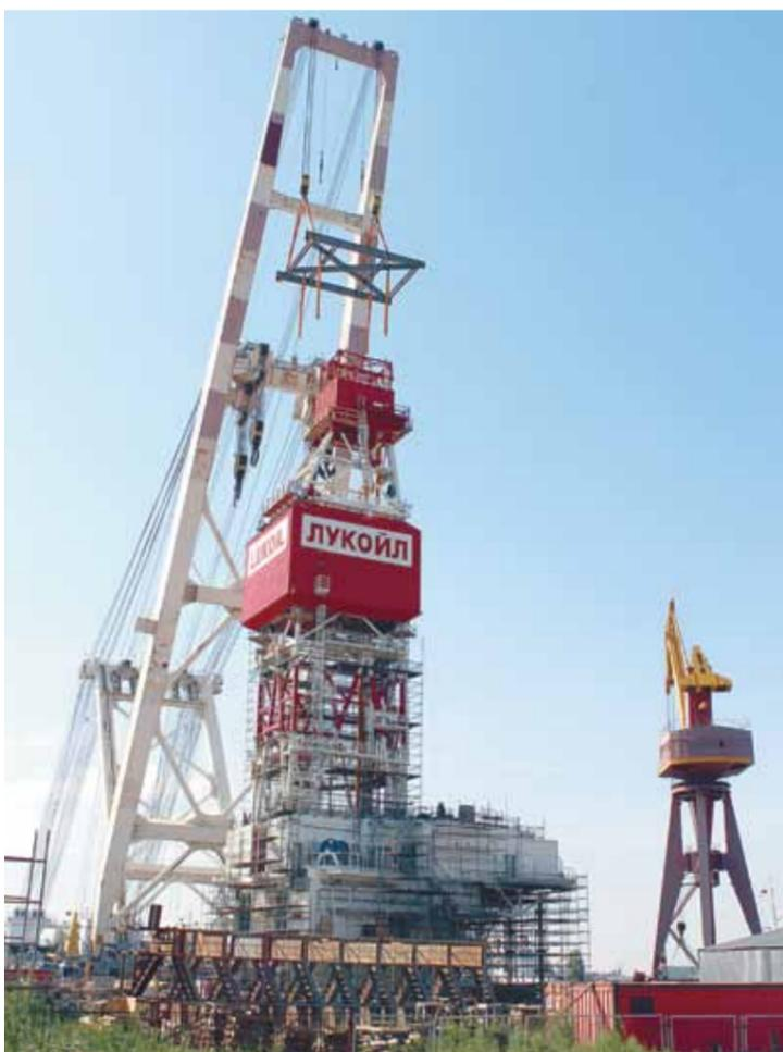
Кронблок предназначен для поддержания на весу инструмента или обсадных труб, а также для спуско-подъемных и технологических операций при проходке скважин. Оборудование установили на наголовник буровой вышки.
